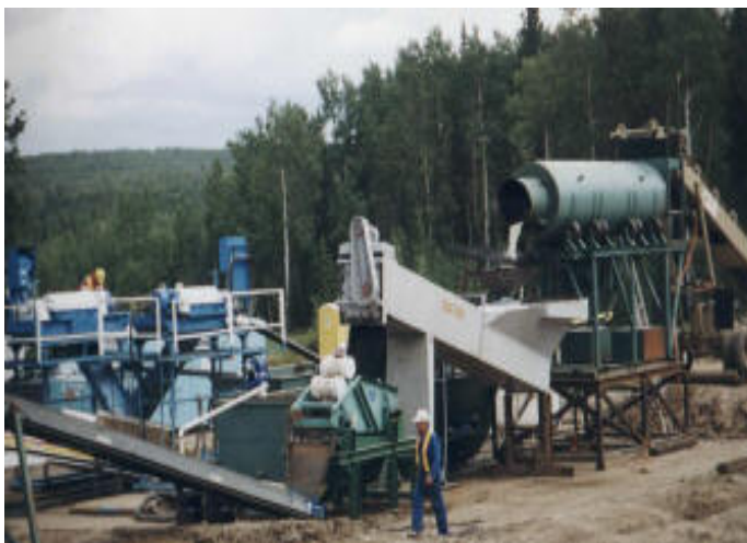
Εικόνα 5-1: Εξοπλισμός και τμήματα συστημάτων εδαφικής πλύσης on-site ( http://art-engineering.com ).
